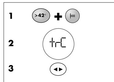
Houd de toetsen **>42 ° + hydromassage (1)** gedurende tenminste 5 seconden ingedrukt totdat trC **(2)** op het display verschijnt. (Afbreken is mogelijk door nogmaals op de toets **>42 °** te drukken.) Druk nu de **MODE-toets (3)** in: het reset-proces wordt uitgevoerd.
