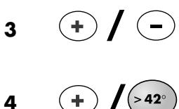
Ahora es posible ducharse. Accionando las teclas +/- (3) puede ajustarse la temperatura. Pulsando simultáneamente las teclas + y > 42° (4) se alcanzan unas temperaturas de ducha superiores a los 42°C.
