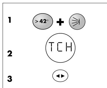
Seguidamente, pulsar primero la tecla **>42° y adicionalmente la tecla Ducha lateral (1)** hasta que aparezca TCH (2) en el display. A continuación pulsar la tecla **MODO (3)**: la adaptación del motor se ejecuta automáticamente.
