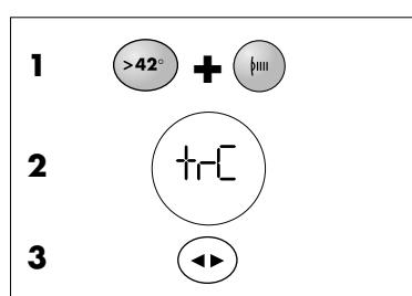
Pulse las teclas **>42° + Hidromasaje (1)** durante al menos 5 segundos, hasta que aparezca trC (2) en el display. (Volviendo a pulsar la tecla **>42°** puede cancelarse el proceso). Pulse la tecla **MODO (3)**: Se ejecuta el proceso de reset.
