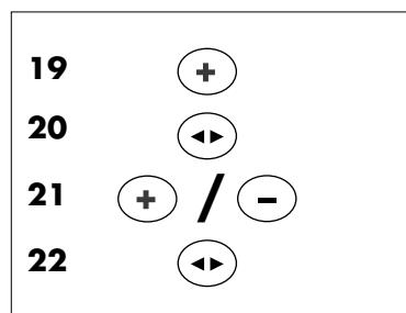
Mit der **Taste + (19)** kommt man zum nächsten Programm-Punkt **P04**. Durch Drücken der **MODE-Taste (20)** erscheint der Wert 2 min. Mit den Tasten **+/- (21)** ist der Wert innerhalb der Grenzen 1 min. bis 50 min. einstellbar. Gespeichert wird mit der **MODE-Taste (22)**. Das Display zeigt die Anzeige **P04**.
