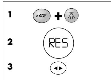
Pulse las teclas **>42° + Ducha fija (1)** durante al menos 5 segundos, hasta que aparezca RES (2) en el display. (Volviendo a pulsar la tecla **>42°** puede cancelarse el proceso). Pulse la tecla **MODO (3)**: Se ejecuta el proceso de reset.
