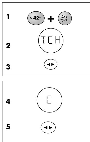
Maintenant, appuyer tout d'abord sur la touche **> 42° et simultanément sur la touche douchette latérale (1)** jusqu'à ce que l'indication TCH (2) s'affiche à l'écran. Appuyer alors sur la touche **MODE (3)** : l'ajustement du moteur s'effectue automatiquement.
