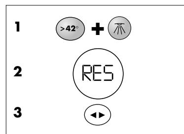
Houd de toetsen **>42 °C + douchekop boven (1)** gedurende ten minste 5 seconden ingedrukt, totdat RES **(2)** op het display verschijnt. (Afbreken is mogelijk door nogmaals op de toets **>42 °** te drukken.) Druk nu op de **MODE-toets (3)**: het reset-proces wordt uitgevoerd.
