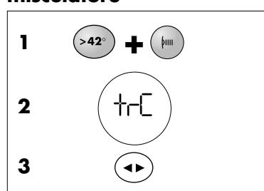
Premere contemporaneamente i tasti **>42° + Idromassaggio (1)** per almeno 5 secondi fino a quando sul display non sarà apparsa la voce **trC (2)**. (Premendo nuovamente il tasto **>42°** è possibile interrompere l'operazione in corso). Premere il Tasto **MODO (3)**: L'operazione di ripristino è stata eseguita.
