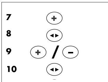
Mit der **Taste + (7)** kommt man zum nächsten Programm-Punkt **P01**. Durch Drücken der **MODE-Taste (8)** erscheint der Wert 32 °C. Mit den Tasten **+/- (9)** ist der Wert innerhalb der Grenzen 10 °C bis 32 °C einstellbar. Gespeichert wird mit der **MODE-Taste (10)**. Das Display zeigt die Anzeige **P01**.
