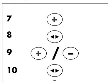
Con la tecla **+** (7) se llega al siguiente opción del programa P01, para el límite de reposición inferior. Pulsando la tecla **MODO (8)** aparece el valor 32°C. Con las teclas **+/- (9)** puede ajustarse el valor entre los límites 10 °C y 32 °C. Para almacenarlo debe pulsarse la tecla **MODO (10)**. El display indica P01.
