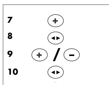
Tramite il tasto **+** (7) si accede al successivo punto di programma P01, relativo al Limite di ripristino inferiore. Premendo il Tasto **MODO (8)** si visualizza il valore 32°C. Operando con i tasti **+/- (9)** è possibile impostare il valore tra 10 °C e 32 °C. Per memorizzare l'impostazione, premere il Tasto **MODO (10)**. Sul display appare: P01.
