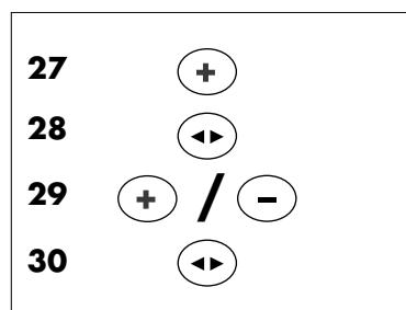
Mit der **Taste + (27)** kommt man zum nächsten Programm-Punkt **P07**. Durch Drücken der **MODE-Taste (28)** erscheint der Wert 1. Mit den Tasten **+/- (29)** ist der Wert 0 (Nein) oder 1 (Ja) einstellbar. Gespeichert wird mit der **MODE-Taste (30)**. Das Display zeigt die Anzeige **P07**.
