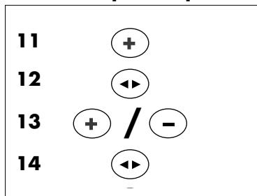
Con la tecla **+** (11) se llega al siguiente opción del programa P02, para el límite de ajuste superior de la temperatura de ducha. Pulsando la tecla **MODO (12)** aparece el valor 55 °C. Con las teclas **+/- (13)** puede ajustarse el valor entre los límites 40 °C y 60 °C. Para almacenarlo debe pulsarse la tecla **MODO (14)**. El display indica P02.
