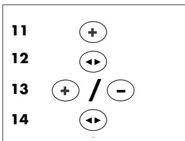
Mit der **Taste + (11)** kommt man zum nächsten Programm-Punkt **P02**. Durch Drücken der **MODE-Taste (12)** erscheint der Wert 55 °C. Mit den Tasten **+/- (13)** ist der Wert innerhalb der Grenzen 40 °C bis 60 °C einstellbar. Gespeichert wird mit der **MODE-Taste (14)**. Das Display zeigt die Anzeige **P02**.
