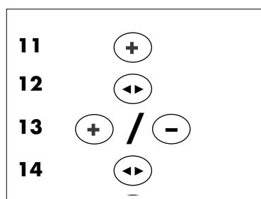
Met de toets **+** **(11)** komt u bij de volgende programmapunt P02 voor de bovenste instelgrens van de douchetemperatuur. Wanneer de **MODE-toets** **(12)** wordt ingedrukt, verschijnt de waarde 55 °C. Met de toetsen **+/-** **(13)** kan de waarde tussen 40 °C en 60 °C worden ingesteld. De instelling wordt opgeslagen met de **MODE-toets** **(14)**. Op het display verschijnt P02.
