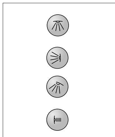
L'installation se trouve en mode «sleep» (arrêt), mode indiqué par un point clignotant affiché à l'écran. En appuyant sur n'importe quelle touche, l'on met l'installation en mode «stand by» (prêt à fonctionner). Le fond de l'écran est maintenant éclairé, le fond des touches est faiblement éclairé. La commande est prête à fonctionner.
