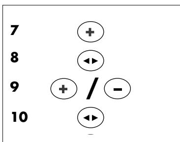
En appuyant sur la touche **+** **(7)**, l'on accède au point du programme suivant, **P01**, limite inférieure de la température de remise en marche. L'on appuie ensuite sur la touche **MODE** **(8)** et la valeur **32 °C** s'affiche à l'écran. Les touches **+/-** **(9)** permettent alors de régler cette valeur entre les limites **10 °C** et **32 °C**. L'enregistrement s'effectue à l'aide de la touche **MODE** **(10)**. L'écran affiche l'indication **P01**.
