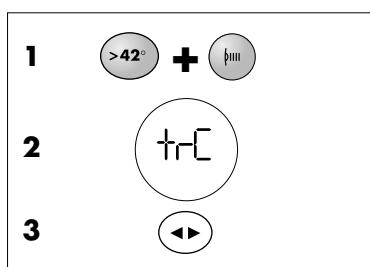
Appuyer sur les touches **> 42° + hydromassage (1)** pendant 5 secondes au minimum, jusqu'à ce que l'indication trC (2) s'affiche à l'écran. (Possibilité d'interrompre le processus en réappuyant sur la touche **> 42°**.) Appuyer ensuite sur la touche **MODE (3)**: le processus de remise à l'état initial s'exécute.
