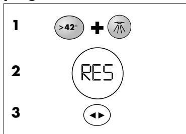
Appuyer sur les touches **> 42° + douche zénithale (1)** pendant 5 secondes au minimum, jusqu'à ce que l'indication RES (2) s'affiche à l'écran. (Possibilité d'interrompre le processus en réappuyant sur la touche **> 42°**.) Appuyer ensuite sur la touche **MODE (3)**: le processus de remise à l'état initial s'exécute.
