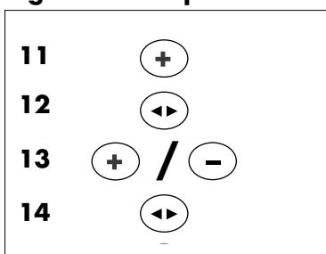
En appuyant sur la touche **+** **(11)**, l'on accède au point du programme suivant, **P02**, limite supérieure de réglage de la température de douche. L'on appuie ensuite sur la touche **MODE** **(12)** et la valeur **55 °C** s'affiche à l'écran. Les touches **+/-** **(13)** permettent alors de régler cette valeur entre les limites **40 °C** et **60 °C**. L'enregistrement s'effectue à l'aide de la touche **MODE** **(14)**. L'écran affiche l'indication **P02**.
