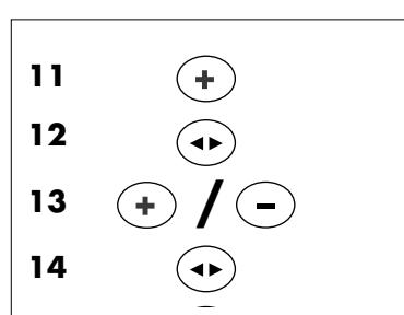
Tramite il tasto **+** (11) si accede al successivo punto di programma P02, relativo a Limite superiore d'impostazione della temperatura di doccia. Premendo il Tasto **MODO (12)** appare il valore 55 °C. Operando con i tasti **+/- (13)** è possibile impostare il valore tra 40 °C e 60 °C. Per memorizzare l'impostazione, premere il Tasto **MODO (14)**. Sul display appare: P02.
