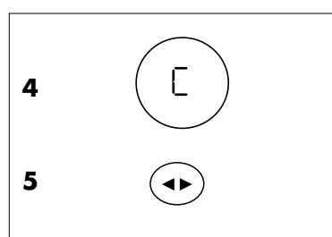
Wanneer de motorinstelling is beëindigd, verschijnt op het display de weergave C (4). Met de toets **MODE** (5) wordt de motorinstelling opgeslagen.
