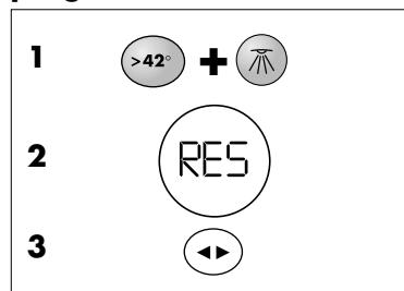
Premere contemporaneamente i tasti **>42° + Soffione doccia centrale (1)** per almeno 5 secondi fino a quando sul display non sarà apparsa la voce **RES (2)**. (Premendo nuovamente il tasto **>42°** è possibile interrompere l'operazione in corso). Premere il Tasto **MODO (3)**: L'operazione di ripristino è stata eseguita.
