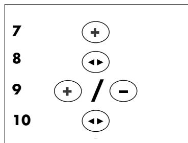
Met toets **+** **(7)** komt u bij de volgende programmapunt P01 voor de onderste instelgrens. Wanneer de **MODE-toets** **(8)** wordt ingedrukt, verschijnt de waarde 32 °C. Met de toetsen **+/-** **(9)** kan de waarde tussen 10 °C en 32 °C worden ingesteld. De instelling wordt opgeslagen met de **MODE-toets** **(10)**. Op het display verschijnt P01.
