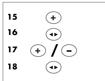
Mit der **Taste + (15)** kommt man zum nächsten Programm-Punkt **P03**. Durch Drücken der **MODE-Taste (16)** erscheint der Wert 15 min. Mit den Tasten **+/- (17)** ist der Wert innerhalb der Grenzen 1 min. bis 50 min. einstellbar. Gespeichert wird mit der **MODE-Taste (18)**. Das Display zeigt die Anzeige **P03**.
