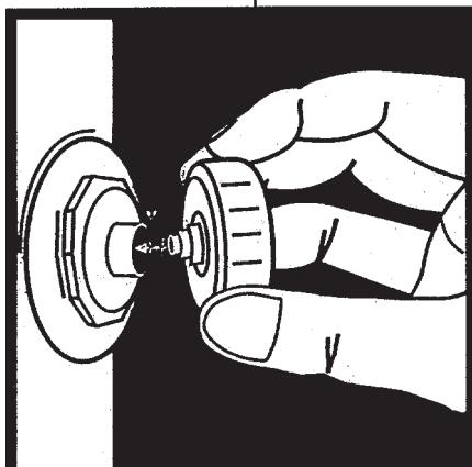
Per Aufsatz kann die Strahlart der Seitenbrausen verändert werden: er wird einfach auf die Brause aufgesteckt.
