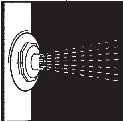
Die Seitenbrause im Normalbetrieb: Turbostrahl, kleiner Brausenradius. Der Strahlwinkel ist individuell einstellbar.
