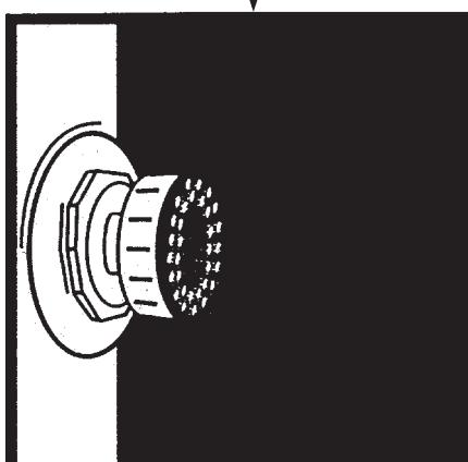
Die Seitenbrause mit Aufsatz: weicher Strahl, größerer Radius. Der Aufsatz kann ganz leicht wieder abgezogen werden.
