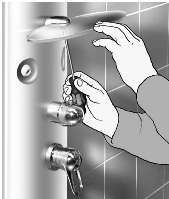
1 Wandmontage + Eckmontage: Glasablage montieren.
