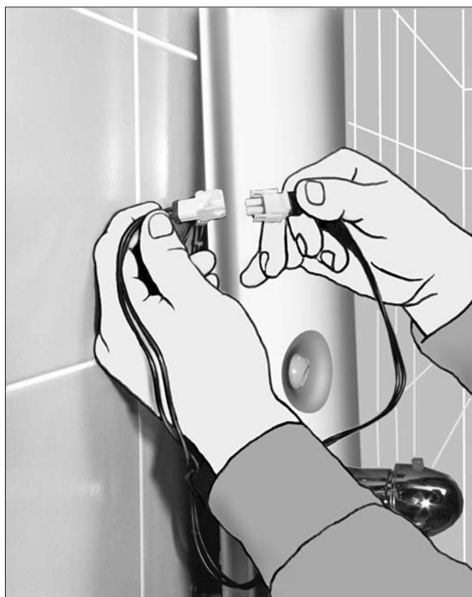
3 12 V Leitung durch Leerrohr führen und Trafo anschließen. Für Servicezwecke sollte ca. 1 m Kabel hinter dem Paneel verbleiben (nur DP Presitge mit Licht).
