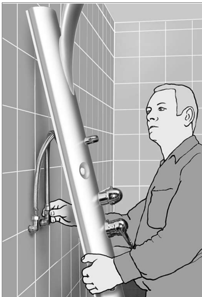
2 Paneel einhängen, Wasser anschließen, Dichtheitsprüfung durchführen (Die Armatur muss nach den gültigen Normen montiert, gespült und geprüft werden!).
