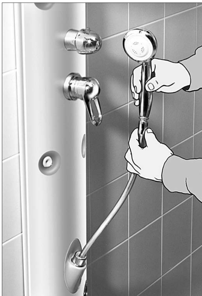
2 Wandmontage + Eckmontage: Handbrause Mistral anschließen (Dichtring einsetzen).
