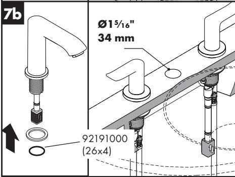
Si l'orifice de bec mesure moins de 34 mm (1 5/16 po), jetez le joint torique de 26 x 4 mm. Installez la rondelle sur le bec.
