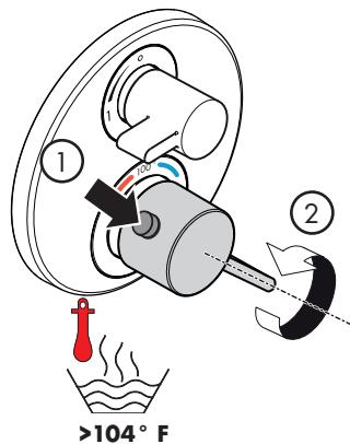
**Check valve maintenance / Entretien de les clapets anti-retour/ Mantenimiento de las válvulas antirretorno**
