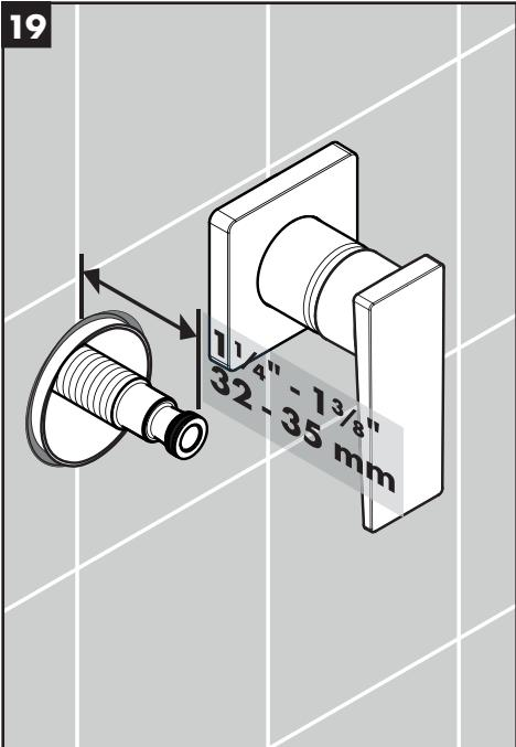
La raccord fileté doit être installé de façon à ce qu'une partie de  $1\frac{1}{4}$  po à  $1\frac{3}{8}$  po (32 - 35 mm) soit à l'extérieur du mur fini.
