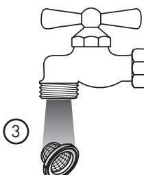
Retire el surtidor de la manguera tipo tirador.
