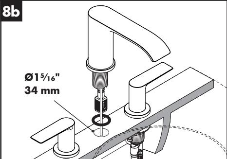
Si l'orifice de bec mesure moins de 34 mm ( $1\frac{5}{16}$  po), jetez le joint torique de 26 x 4 mm.
