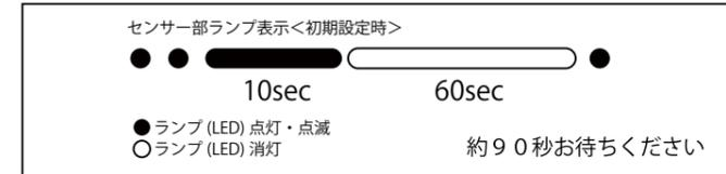
②初期調整作業完了。ご使用いただけます。
