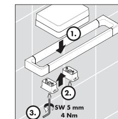
アダプターセットのブロックをレールを挟むようにプレートに取り付けます。
