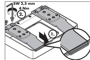
アダプターセットのプレートを取り付けます
