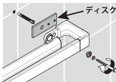
壁面に不陸がある場合は、製品付属のディスクを本体と壁の間に挟むことで解消できます。
