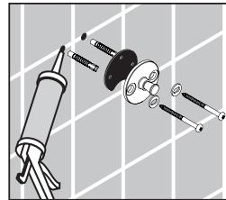
プラグを挿入後、止水処理（コーティング等）をし、
