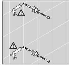
プラグを挿入後、止水処理（コーティング等）をし、
