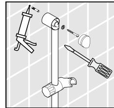
プラグを挿入後、止水処理（コーティング等）をし、ビスでウォールバーを取付けてください。
