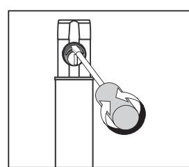
ビス締め付けの前に、マイナスドライバーにて、取付位置の微調整が可能です。
