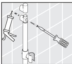
プラグを挿入後、止水処理（コーティング等）をし、ビスでウォールバーを取付けてください。
