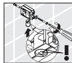
プラグを挿入後、止水処理（コーティング等）をし、
