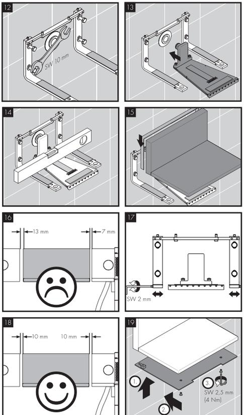
12. 取付アームのビスを締め付けます(本締め)。
