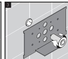
3. 防水シートを挟むように接続スレッドを取り付けます。
