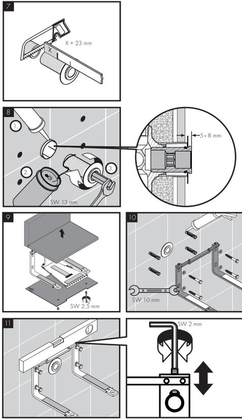
7. x寸法とマニュアル記載の寸法を足した長さで接続スレッドを切断します。
