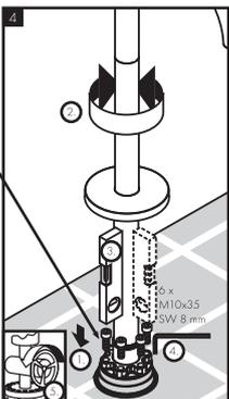
埋込部とセットする製品の取付 壁取り付け
