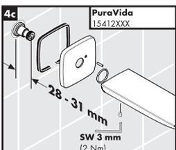
壁仕上面と化粧台座及びスパウトとの間にすきまが生じてしまいますので、壁仕上面からニップル先端までの寸法を、必ず各製品図面に記載しております許容範囲内となるようにニップルを締め込んでください。ニップルが長い際には、許容範囲内となるようニップルを切断してください。
