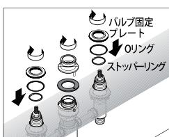
ストップバーリングを取り付面の浴槽リム上部より、それぞれ左右のバルブハウジングの切り欠きに合わせて取り付けます。O-リングをそれぞれのバルブ固定プレートに取り付けて、ストップバーリングをそれぞれのバルブ固定プレートに取り付けて、中央のスパウトハウジングには、浴槽リム上部よりスパウト受け金具とシートバッキンを奥まで取付けます。スパウト受け金具の固定ピンを、浴槽リムの穴に必ず通してください。吐水口ゆるみの原因になります。
