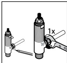
接続用銅管に圧縮カッピングナット、圧縮リングを通し、バルブハウジング（左右）、スパウトハウジング（中央）に接続します。
