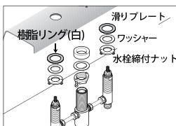
滑りプレート、ワッシャー、水栓締付ナットをスパウトハウジングと両サイドのバルブハウジングに奥までねじ込んで仮付けし、取付面下部より水栓取付穴に通します。各部品の順序を間違えないようにご注意ください。
