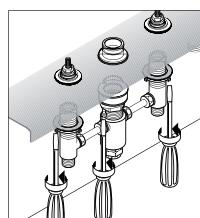
浴槽リム下部より、各ハウジングの水栓締付ナットを手でできる限り強く締付けてください。
