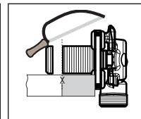
②取付アダプターを用いて取付穴を印してください。
