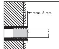
①取付アダプターの接続スレッドを下図寸法（Xmm）に切断してください。
