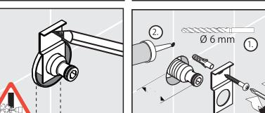
③取付金具を用いて取付穴を印してください。
