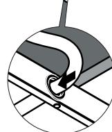
天井とボックスの隙間をシール材(コーキング材)にて埋めます。
