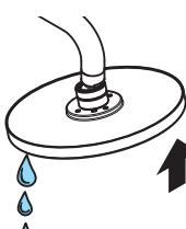
長期間しない場合は、散水板を傾けて、中に残っている残水を出します。※角度調整可能な製品のみ
