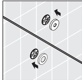
(8) シャワーパイプを上部和下部の壁フランジに取り付けてください。
