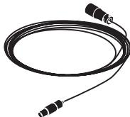
No se puede acortar el cable del bloque de válvulas magnéticas (longitud aproximada: 7,5m) ni el cable de iluminación (longitud aproximada: 10m). Si es necesario, enrolle los cables cerca del receptor.
