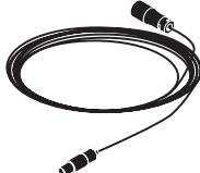
Vod bloka magnetskih ventila dugačak 7,50 m, te svetlosni vod dužine 10,00 m, se ne smeju skraćivati. Nepotrebnu dužinu treba ostaviti u blizini prijemnika. Vod bloka magnetnih ventila sme se polagati samo u isporučenu praznu cev (EN 20). Prazna cev se mora fiksirati najviše na svakih 500 mm, a poluprečnik savijanja mora biti veći od 100 mm.
