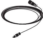
Den 7,50 m lange magnetventilblokledning som også den 10,00 m lange lysledning må ikke afkortes. Det stykke ledning, som ikke bruges, bør opbevares i nærheden af sikkerhedstransformeren.
