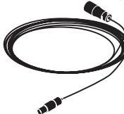
Non accorciare il cavo lungo 7,50 m del blocco di elettrovalvole e il cavo luce lungo 10,00 m. La lunghezza cavo non necessaria dovrebbe essere collocata nelle vicinanze del ricevitore.
