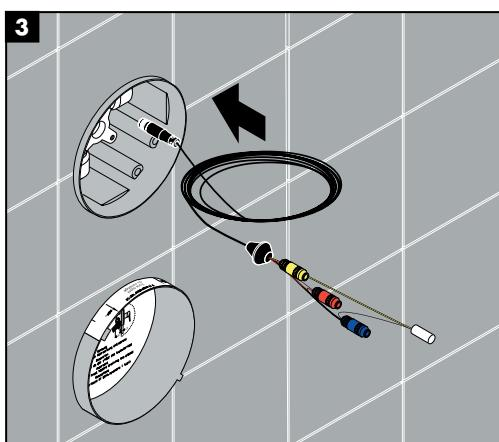
**DE** Magnetventilleitung mit Hilfe eines Kabeleinzugsgerätes in das Leerrohr (EN 20) einziehen.
