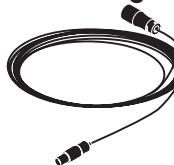
De leiding van het magneetventielblok van 7,50 m lang en de 10,00 m lange verlichtingsleiding mogen niet verkort worden. De overbodige kabellengte moet ondergebracht worden in de buur van de ontvanger.
