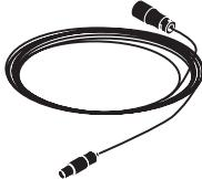
7,50 m uzunluğundaki manyetik valf bloğu hattı ve 10,00 m uzunluğundaki aydınlatma hattı kısaltılmamalıdır. İhtiyaç duyulmayan hat uzunluğu alıcının yakınına konulmalıdır.
