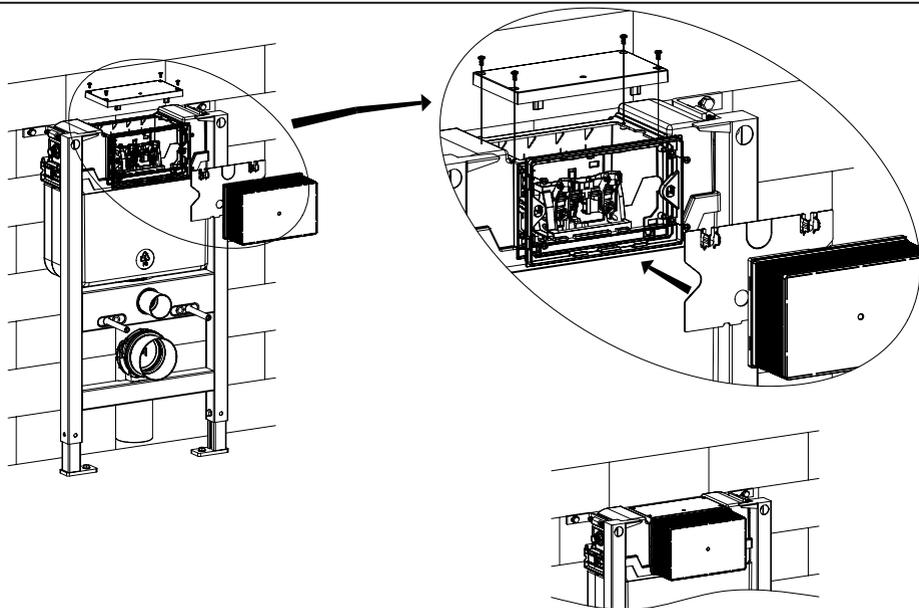
安装完成图 / Finished assembly drawing
