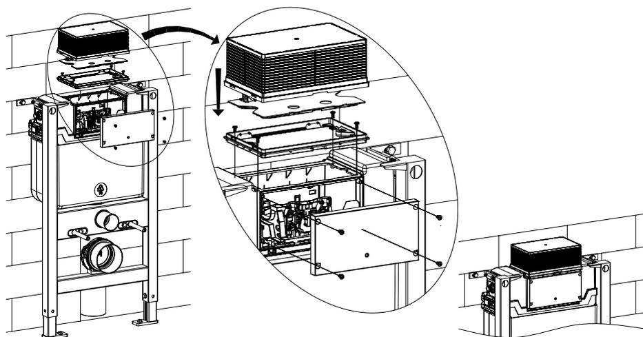
安装完成图 / Finished assembly drawing
