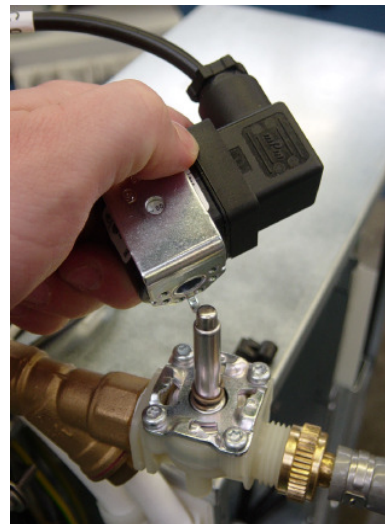
Entfernen der Spule
