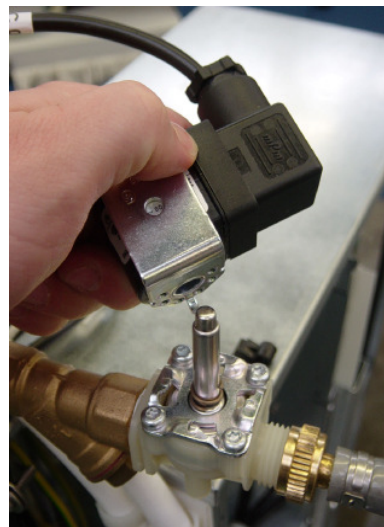
Rimozione della bobina
