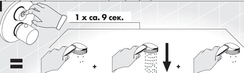
Старт: кнопку "старт - стоп" нажать еще раз и удерживать нажатой до тех пор, пока потребитель самостоятельно не прекратит излив воды, после этого кратковременно опять начнет и потом опять самостоятельно прекратит излив воды. После этого отпустить кнопку "старт - стоп".
