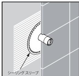
シーリングスリーブを埋込部に取付け、壁面に接着してください。貫通部をより効果的に止水させるため、コーキング処理に加えて、シーリングスリーブを使用することをおすすめします。
