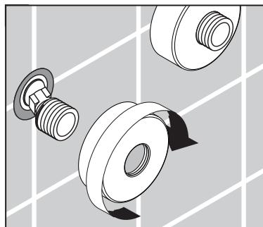
混合水栓本体を取り付けます。取り付けの際、付属のストレーナーパッキンの向きに注意して取付けます。
