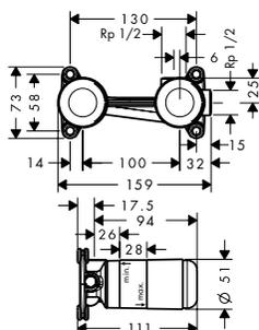
Corps d'encastrement pour mitigeur de lavavo encastré au mur
