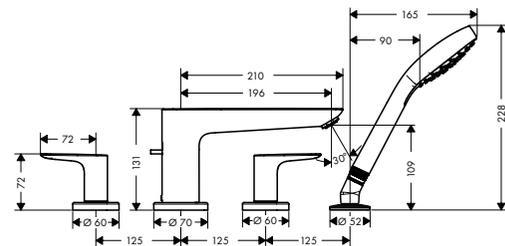
Set de finition Mélangeur 4 trous pour montage sur bord de baignoire
