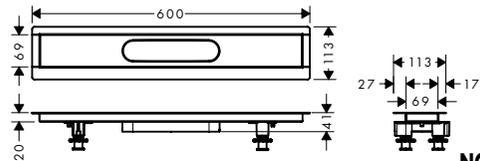
**RainDrain** Kit d'installation 600 mm pour caniveau de douche linéaire encastré dans le sol à carreler
