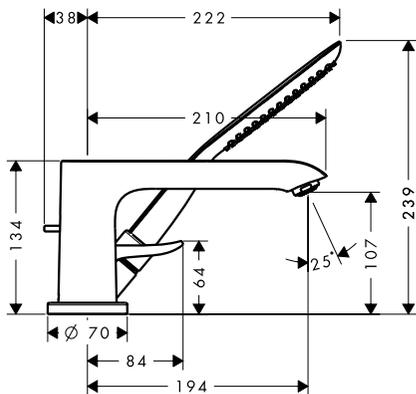
**Set de finition mitigeur 3 trous pour montage sur bord de baignoire**
