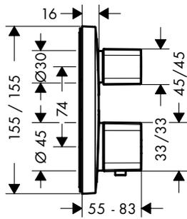
**Ecostat E** Set de finition pour mitigeur thermostatique encastré avec robinet d'arrêt et inverseur
