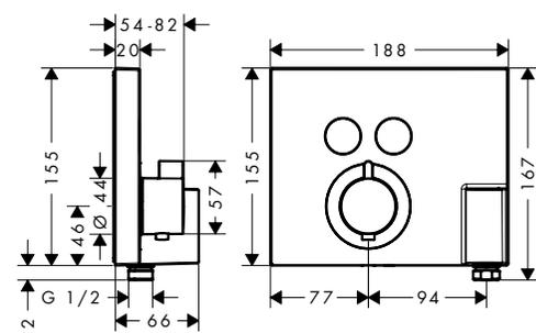
**ShowerSelect Set de finition pour mitigeur thermostatique encastré avec 2 fonctions, fixfit et porter**
