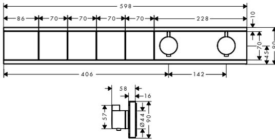
**RainSelect** Module thermostatique RainSelect encastré avec 4 fonctions
