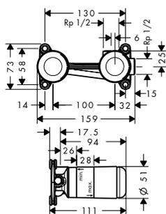
**Corps d'encastrement pour mitigeur de lavabo encastré au mur**
