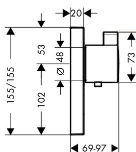
**ShowerSelect** Set de finition pour mitigeur thermostatique encastré haut débit avec une sortie permanente et un robinet d'arrêt
