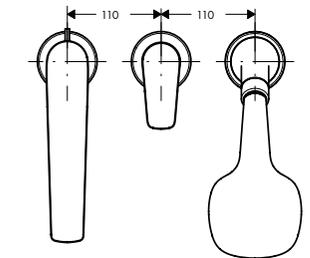
**Set de finition mitigeur 3 trous pour montage sur bord de baignoire**
