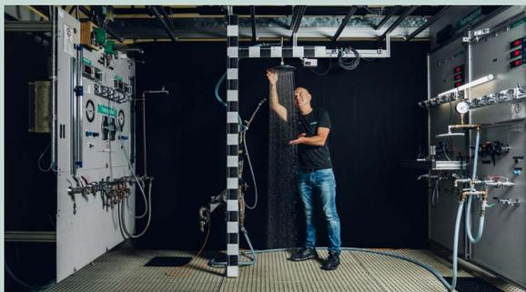
Am Wasserprüfstand nehmen die Hansgrohe Experten das Strahlbild genau unter die Lupe.
