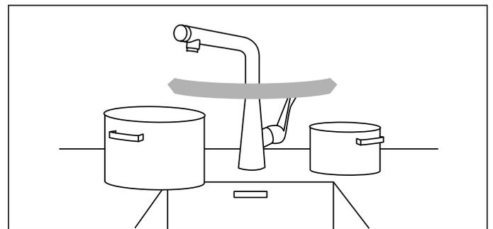
**Schwenkfunktion:** Die Küchenmischer bieten entweder einen begrenzten Schwenkbereich (60°/110°/120°/150°) oder aber Rundumbewegungsfreiheit (360°). Besonders praktisch beim gleichzeitigen Arbeiten rechts und links vom Küchenmischer.
