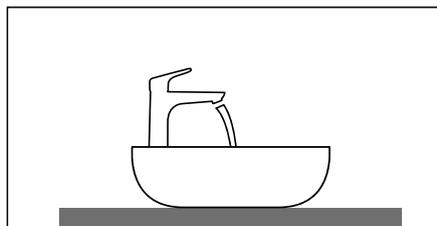
Waschschiessel mit aufgesetzter Armatur.
