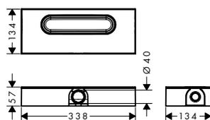
Sperrwasserhöhe: 30 mm
