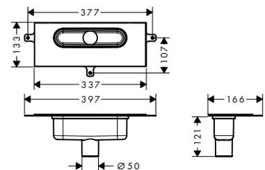
Sperrwasserhöhe: 50 mm
