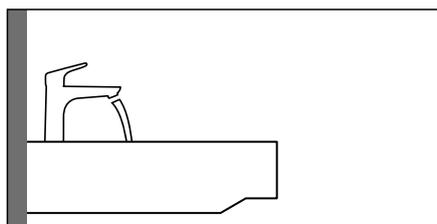
Wandhängendes Waschbecken mit darauf montierter Armatur.
