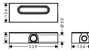
Sperrwasserhöhe: 50 mm
