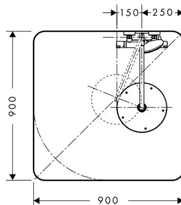
Häufig sind bestehende Wasseranschlüsse nicht mittig in einer Dusche angebracht. Durch den schwenkbaren Brausearm kann die Kopfbrause nach der Montage dennoch zentriert in der Dusche platziert werden.
