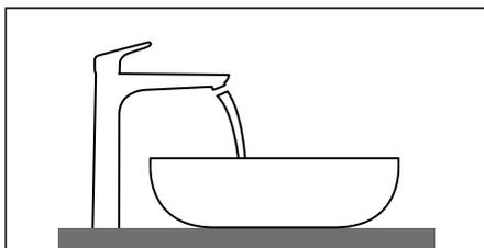
Armatur hinter freistehendem Aufsatzbecken oder hinter Waschschiessel.
