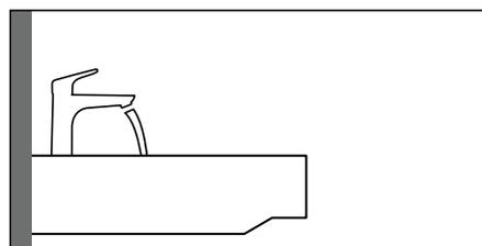
Wandhängendes Waschbecken mit darauf montierter Armatur.
