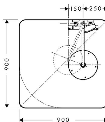
Häufig sind bestehende Wasseranschlüsse nicht mittig in einer Dusche angebracht. Durch den schwenkbaren Brausearm kann die Kopfbrause nach der Montage dennoch zentriert in der Dusche platziert werden.
