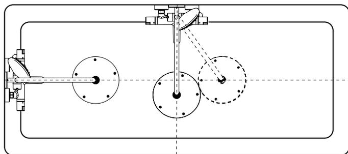
Je nachdem, wo die Wasseranschlüsse angebracht sind, können die Showerpipes problemlos an der Stirn- oder an der Längsseite der Wanne montiert werden. Die Kopfbrause kann dann noch individuell ausgerichtet werden.
