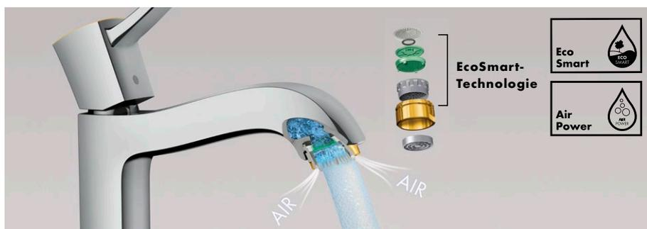
**EcoSmart/AirPower** Während EcoSmart den Durchfluss reduziert und so Wasser und Energie spart, reichert AirPower das einströmende Wasser mit Luft an, damit der Wasserstrahl fülliger, leichter und weicher wird.
