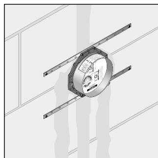
Instalación con guías de montaje
