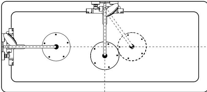
Las Showerpipes pueden montarse fácilmente en la parte frontal o bien lateral de la bañera, según la ubicación de las tomas de agua. El cabezal de ducha también puede orientarse individualmente.
