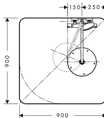
Las tomas de agua existentes no siempre se encuentran en el centro de la ducha. Gracias al brazo de ducha giratorio, el cabezal puede orientarse hacia el centro de la ducha una vez finalizada la instalación.
