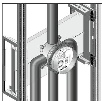
Instalación mediante soportes metálicos
