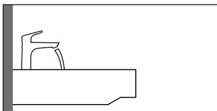
Wandhängendes Waschbecken mit darauf montierter Armatur.
