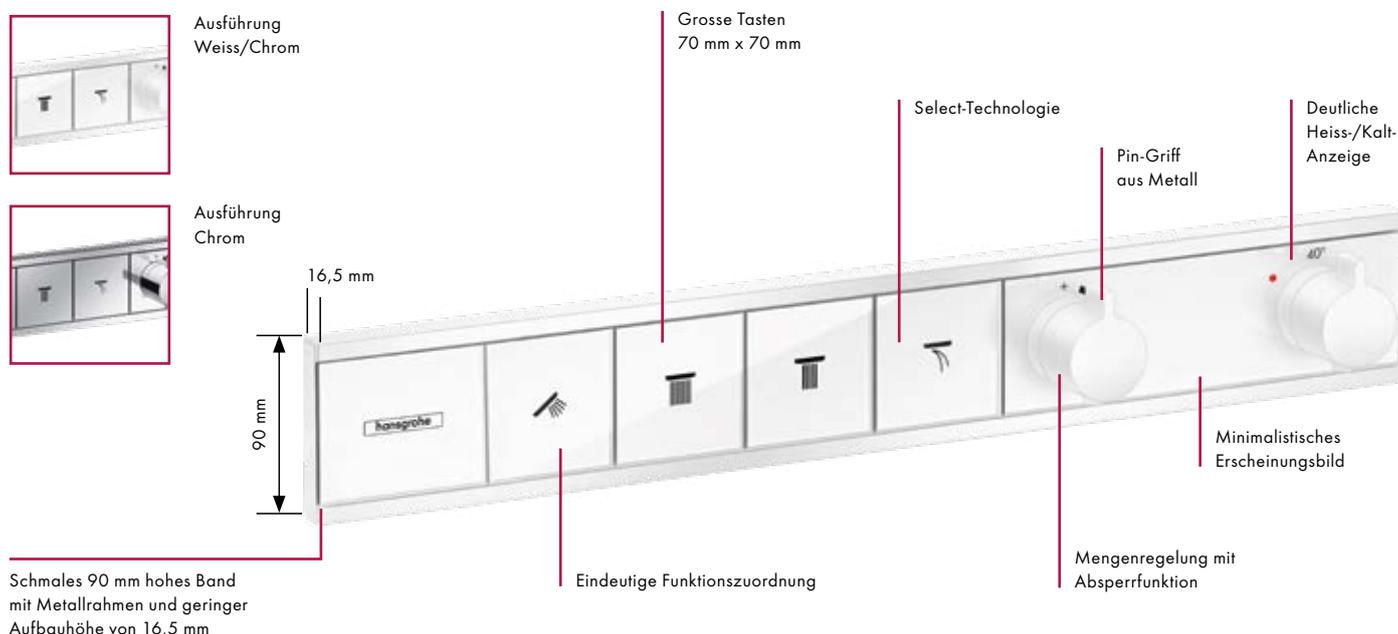
Schmales 90 mm hohes Band mit Metallrahmen und geringer Aufbauhöhe von 16,5 mm
