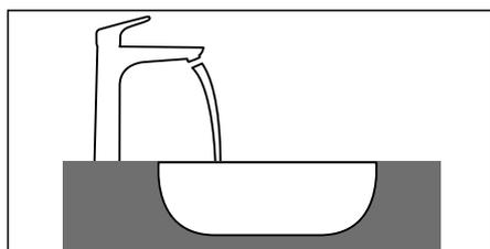
Armatur für Unterbau- bzw. Einbaubecken.
