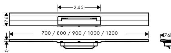
RainDrain Flex pour montage contre le mur
