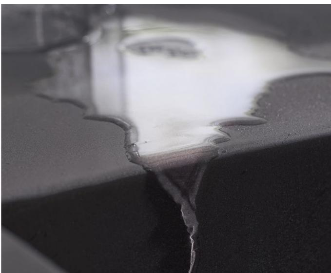
**Abperl-Effekt:** Dank der glatten, porenfreien Oberfläche perlt Wasser einfach ab.
