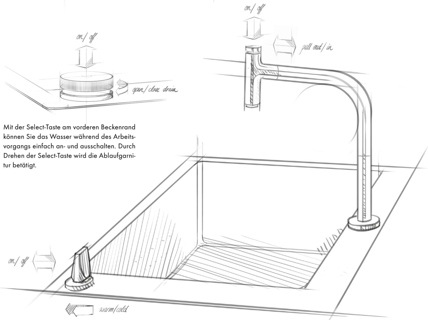
Mit der Select-Taste am vorderen Beckenrand können Sie das Wasser während des Arbeitsvorgangs einfach an- und ausschalten. Durch Drehen der Select-Taste wird die Ablaufgarnitur betätigt.
