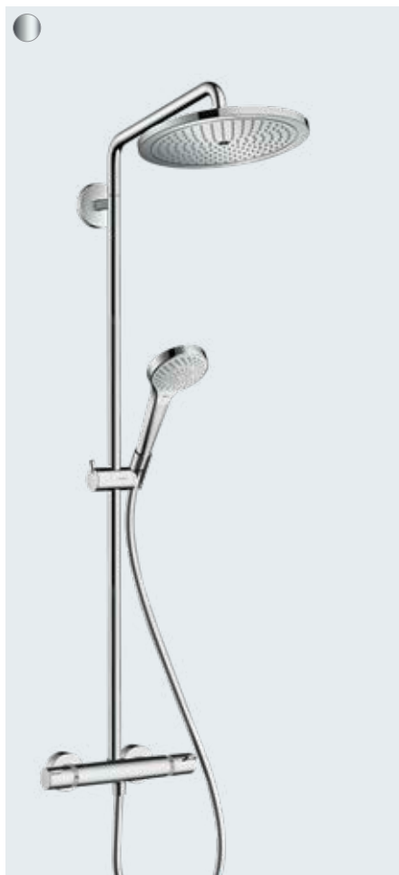
Cromo Select S Showerpipe 280 1jet avec thermostatique Longueur du bras de douche 400 mm Bras de douche pivotant Le tube de la colonne peut être recoupé ▪ Cromo 280 1jet Douche de tête ▪ Cromo Select S Multi Douchette à main ▪ Ecostat Comfort Thermostatique # 26790, -000 16 l/min # 26794, -000 EcoSmart 9 l/min Showerpipe 280 1jet avec thermostatique pour baignoire (non représ.) # 26792, -000
