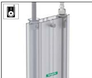
**sBox:** Bei allen ausziehbaren Küchenmischern sorgt die sBox für eine sichere, leichtgängige Ausziehbarkeit und Rückholung des Schlauches. Die 52 cm hohe Box passt in alle gängigen Unterschrankmöbel ab 74 cm.
