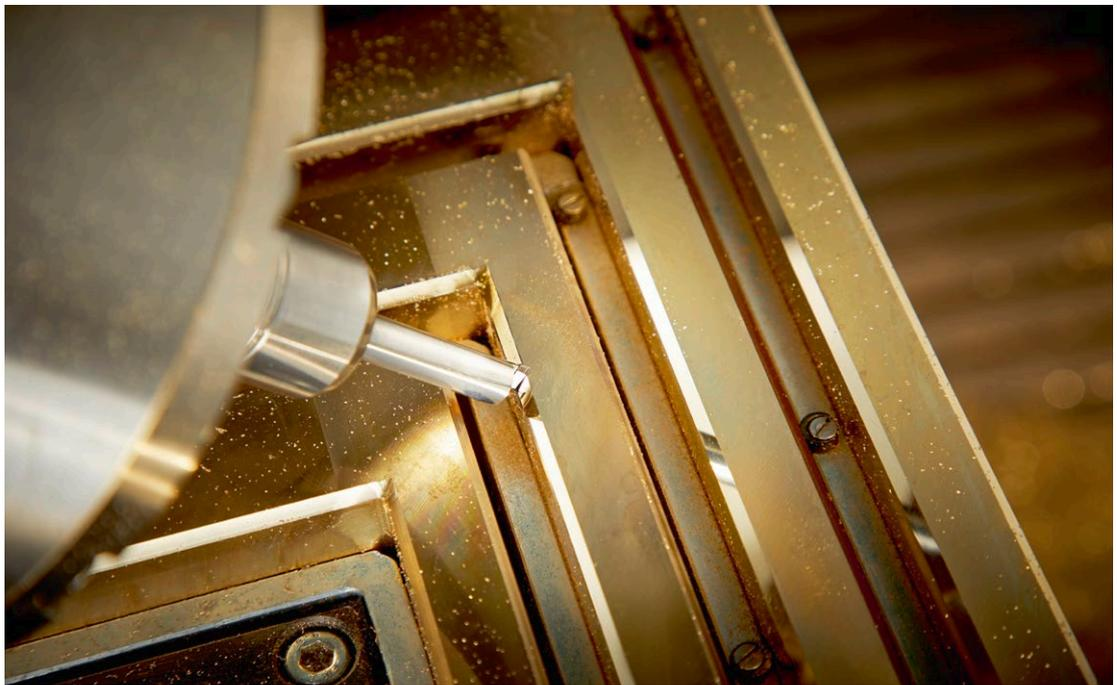
La precisión constituye la base de la brillantez y la manufactura con diamantes establece el indicador de las superficies y bordes perfectos. Se utiliza una máquina de corte por diamante de última generación en aquellos lugares en que se requiere una precisión de una milésima de milímetro y la unión exacta de las aristas a 45°. Desarrollada para la producción de AXOR Edge. Con una herramienta de diamante que se utiliza en el sector de los vuelos espaciales y en la industria de los láseres.
