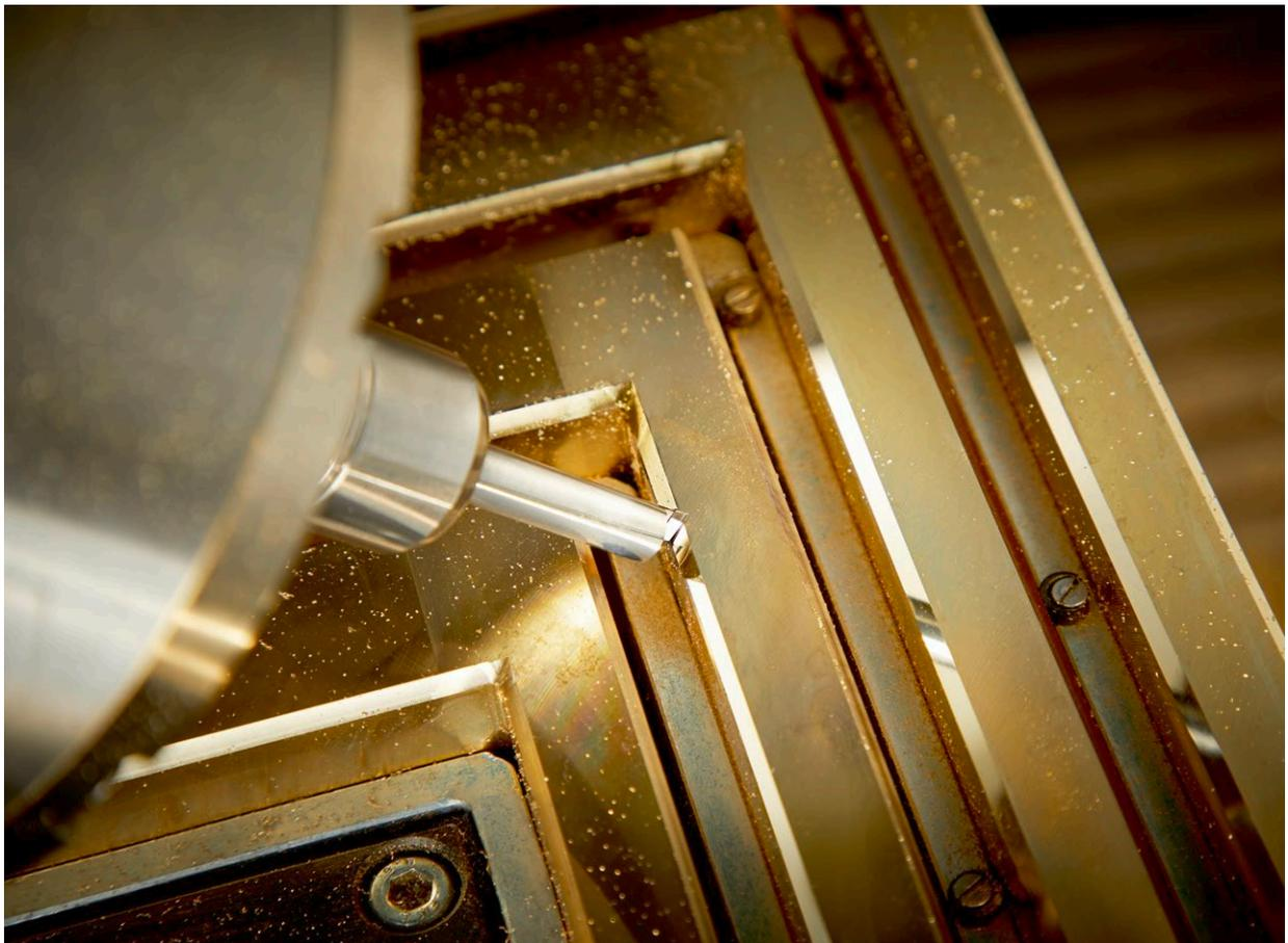
EN HAUT À GAUCHE // Une ligne est fraisée jusqu'à 5 fois, donnant l'impression d'être taillée au diamant.
