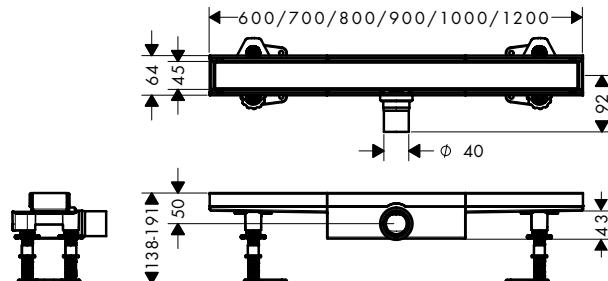
RainDrain Compact pločica za plitku instalaciju
