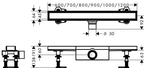
RainDrain Compact pločica za standardnu instalaciju
