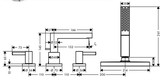
**Finoris Set de finition mélangeur 4 trous pour montage sur bord de baignoire avec sBox**
