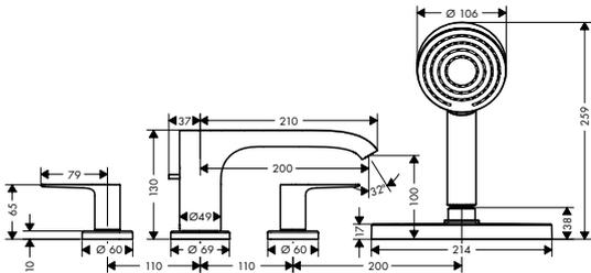
**Vivenis Set de finition mélangeur 4 trous pour montage sur bord de baignoire avec sBox**
