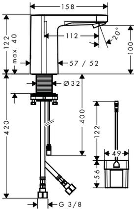
**Vernis Blend Mitigeur de lavabo électronique avec pré-réglage de la température sur batterie**
