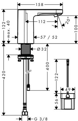
**Vernis Blend Mitigeur de lavabo électronique en eau froide sur batterie**
