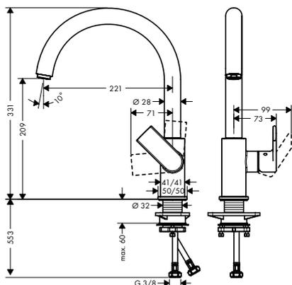
Les mesures des schémas techniques sont en mm.
