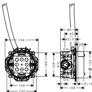
Corps d'encastrement pour mitigeur de lavabo électronique
