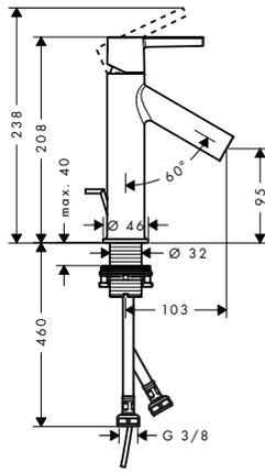
Mitigeur de lavabo avec poignée à levier CoolStart 3,5 l/min avec tirette et vidage
