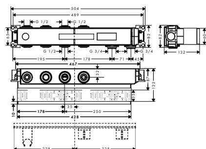
Corps d'encastrement pour module thermostatique 2 fonctions
