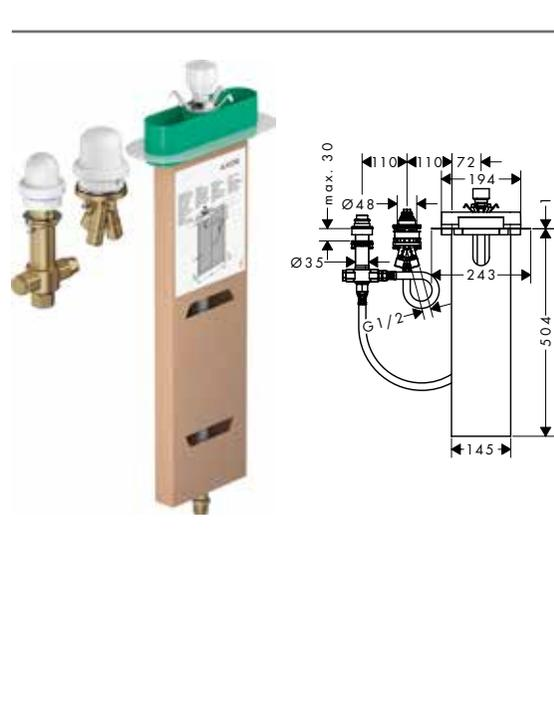
Corps d'encastrement pour combiné mitigeur 3 trous pour montage sur bord de baignoire
