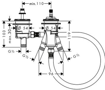
Corps d'encastrement pour thermostatique 2 trous pour montage sur bord de baignoire
