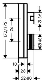
**Thermostatique encastré avec robinet d'arrêt/inverseur**
