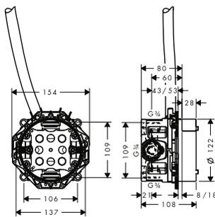
Corps d'encastrement pour mitigeur de lavabo électronique
