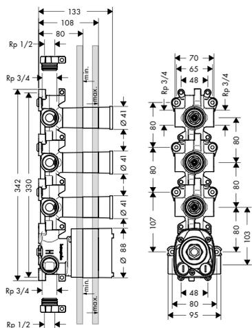
Corps d'encastrement pour module thermostatique 3/4"
