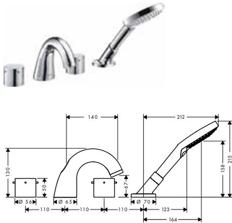
Set de finition Mélangeur 4 trous pour montage sur bord de baignoire avec poignées zéro
