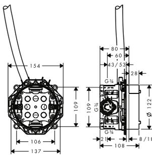
Corps d'encastrement pour mitigeur de lavabo électronique
