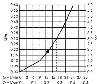
/ Douche de tête 250 / 250 mm 1jet avec raccordement plafond 100 mm # 35308000
