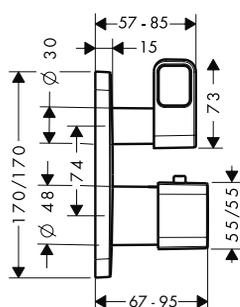
Thermostatique encastré avec robinet d'arrêt/inverseur
