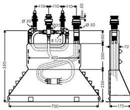
Corps d'encastrement pour combiné mélangeur 4 trous pour montage sur bord de baignoire
