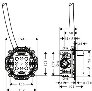
Corps d'encastrement pour mitigeur de lavabo électronique
