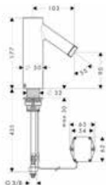
Mitigeur de lavabo électronique avec manette de réglage de température sur batterie
