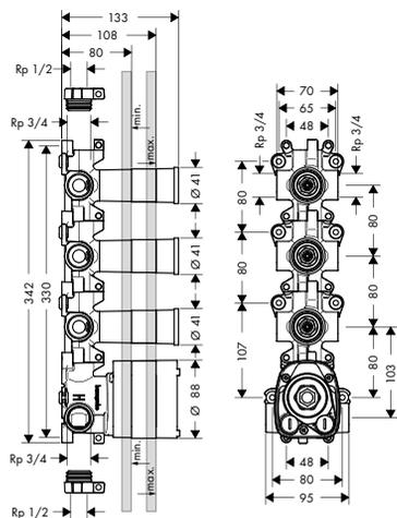
Corps d'encastrement pour module thermostatique 3/4"
