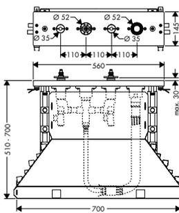
Corps d'encastrement pour batterie mélangeur 4 trous sur plage de carrelage
