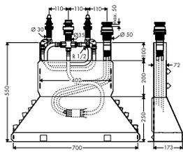
Corps d'encastrement pour combiné mélangeur 4 trous pour montage sur bord de baignoire
