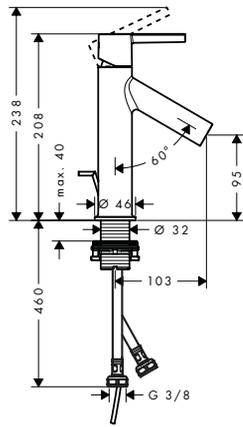
Mitigeur de lavabo avec poignée à levier CoolStart 3,5 l/min avec tirette et vidage
