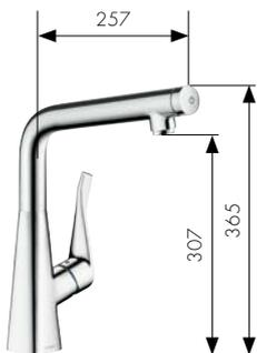
Mitigeur monocommande de cuisine 320 avec bec orientable
