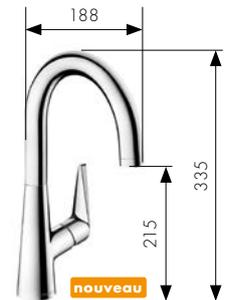
Mitigeur monocommande de cuisine 220 avec bec orientable
