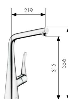
Mitigeur monocommande de cuisine 320 avec bec orientable
