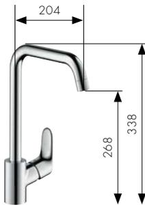
Mitigeur monocommande de cuisine 260 avec bec orientable
