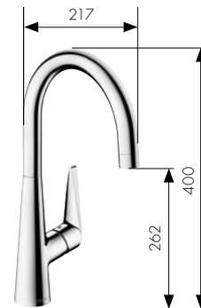
Mitigeur monocommande de cuisine 260 avec bec orientable
