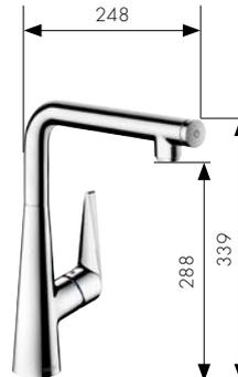
Mitigeur monocommande de cuisine 300 avec bec orientable
