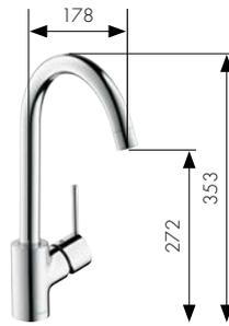
Mitigeur monocommande de cuisine avec bec orientable
