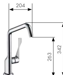
Mitigeur monocommande de cuisine avec bec orientable
