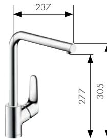
Mitigeur monocommande de cuisine 280 avec bec orientable (bec en L)
