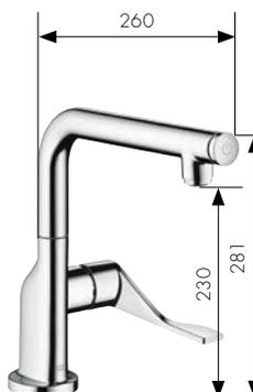
Mitigeur monocommande de cuisine avec bec orientable
