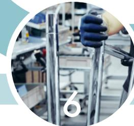
Das **LASERBEARBEITEN UND MONTIEREN** des Produkts führt Grundkörper, Kartusche und weitere Komponenten wie Perlator, Schläuche und Zugstangen zusammen.
