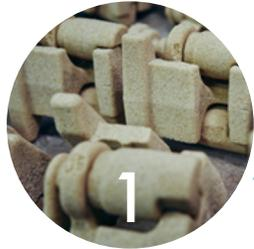
Es folgt das **GIESSEN DES MESSING-KÖRPERS** aus aufgeschmolzenem Messing. Nach dem Erstarren wird der Sand herausgerüttelt.
