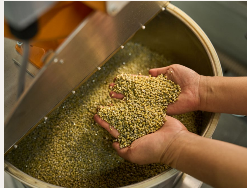
Das aus der Aufbereitungsanlage gewonnene recycelte Kunststoffgranulat kommt für die Herstellung neuer Teile wieder in den Kreislauf.
