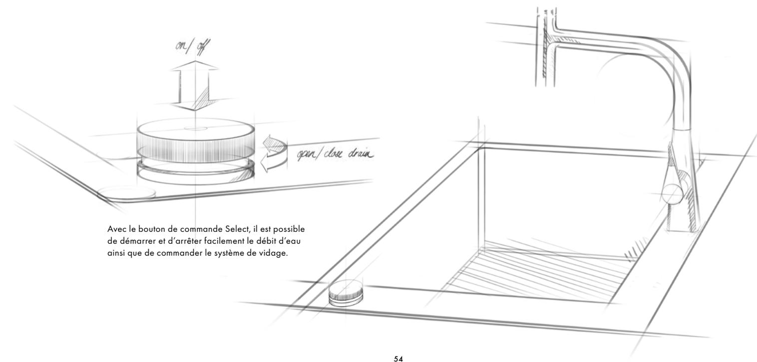
Avec le bouton de commande Select, il est possible de démarrer et d'arrêter facilement le débit d'eau ainsi que de commander le système de vidage.
