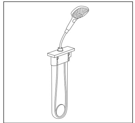
**sBox Baignoire:** Système d'enroulement de flexible pratique pour une esthétique sobre et un confort accru.
