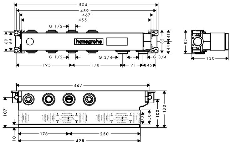
Tous les corps d'encastrement sont montés sur des raccords standard G $\frac{3}{4}$ .
