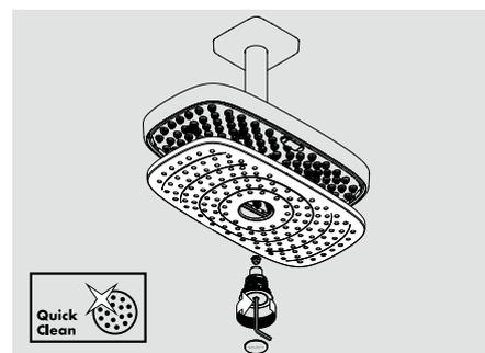
**Nettoyage facile** : comme d'habitude, la fonction QuickClean permet de nettoyer les buses. Le disque de jet se démonte facilement et peut même passer au lave-vaisselle.
