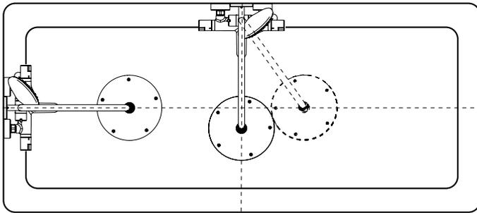
En fonction de l’emplacement des branchements d’eau, les systèmes Showerpipe peuvent être installés facilement sur la paroi frontale ou longitudinale de la baignoire. La douche de tête peut ensuite être positionnée selon les souhaits de chacun.
