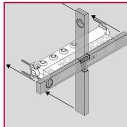
Le corps d'encastrement sert de gabarit de montage. Montage par une seule personne grâce au traçage précédent avec le niveau à bulle
