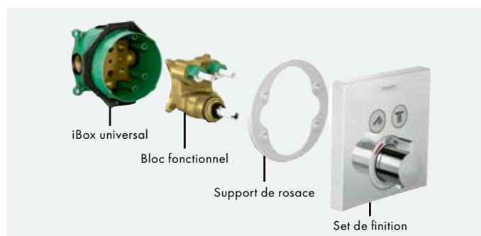
**Durable :** le corps d'encastrement est conservé en cas de rénovation de salle de bains. Le bloc fonctionnel et le set de finition se remplacent aisément.
