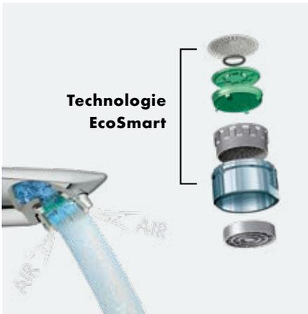
Grâce à la technologie EcoSmart, les mitigeurs de lavabo hansgrohe ne consomment que 5 l/min grâce à l'ajout d'air à l'eau. Cela permet d'économiser de l'eau chaude et ainsi de l'énergie. Nos mitigeurs de lavabo obtiennent respectivement le meilleur résultat avec une classe A dans le secteur Home.
