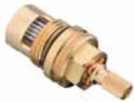
Mécanisme d'arrêt céramique 1/4 de tour , filetage 1/2, fermeture à droite (chaud), pour mélangeurs à manettes.
