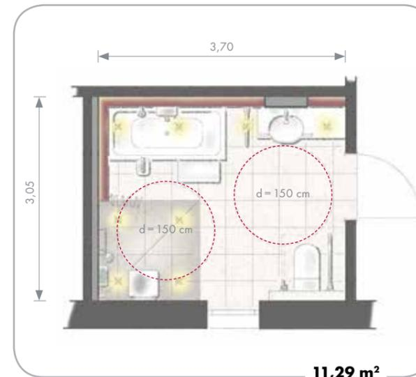
Barrierefreies Bad, rollstuhlgerecht und mit den nach SIA 500 vorgeschriebenen Freiflächen und Hilfsmitteln. Angenehme Raumatmosphäre durch Lichtfächer, ansprechende Farben, kontrastierende Helligkeiten und ästhetische Einbauten.
