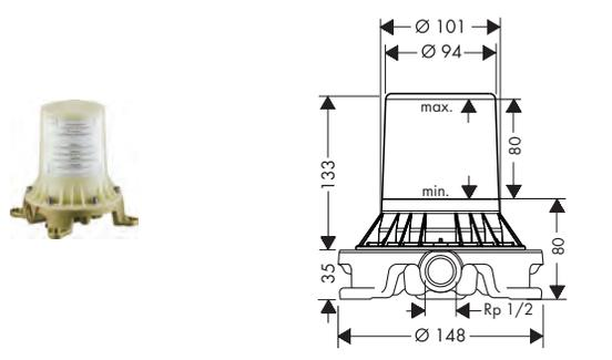
**Corps d'encastrement pour mitigeur/thermostatique à poser**
