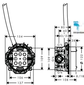
Corps d'encastrement pour mitigeur électronique
