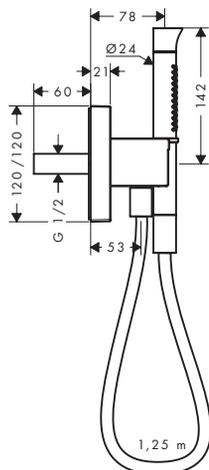
Fixfit Porter 120/120 mm square avec clapet antiretour, douche à main micro 2jet et flexible de douche 1,25 m
