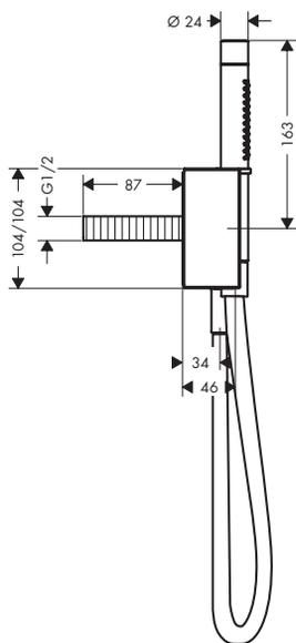
Fixfit Porter 104/104 mm square avec clapet antiretour, douche à main micro 2jet et flexible de douche 1,25 m
