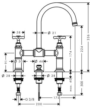
Mélangeur lavabo 220 modèle à pont avec poignées cruciformes et garniture de vidage
