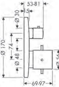
Thermostatique Ø 170 mm avec robinet d'arrêt pour 1 système - set de finition round
