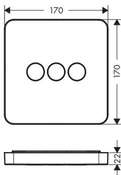
Robinet d'arrêt encastré 170/170 mm pour 3 systèmes - set de finition softcube
