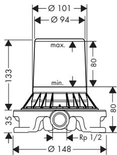
Corps d'encastrement pour mitigeur/thermostatique à poser
