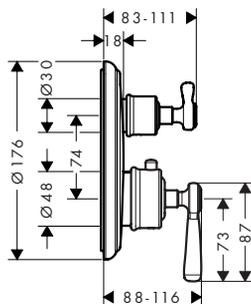
Thermostatique Ø 170 mm avec robinet d'arrêt pour 1 système, poignée droite - set de finition round
