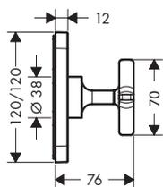
Robinet d'arrêt 120/120 mm avec poignée cruciforme - set de finition softcube
