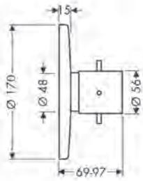
Thermostatique HighFlow Ø 170 mm - set de finition round
