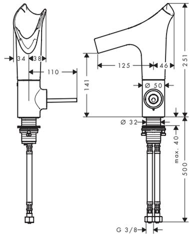
Mitigeur lavabo 140 avec bec déverseur en verre cristal et bonde
