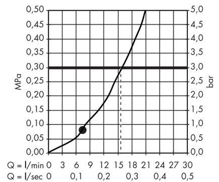
Le débit a été mesuré avec les raccords et diamètres appropriés (thermostatique/mitigeur/robinet d'arrêt) pour refléter la réalité.
