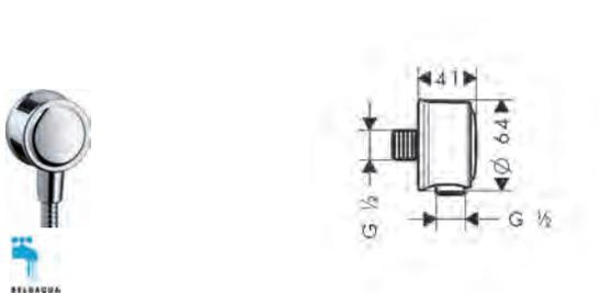
Fixfit avec clapet anti-retour
