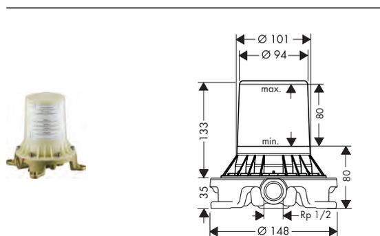
Corps d'encastrement pour mitigeur/thermostatique à poser
