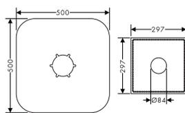
Manchon d'étanchéité pour corps d'encastrement 10452180
