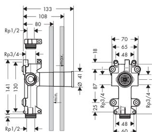
Corps d'encastrement pour robinet d'arrêt 120/120 mm - set de finition square
