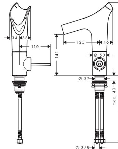
Mitigeur lavabo 140 avec bec déverseur en verre cristal et bonde - coupe diamant
