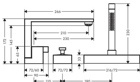
Mitigeur bain/douche 3 trous sur gorge avec bec déverseur 210 mm et douche à main micro 2jet - set de finition
