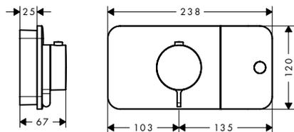
Module thermostatique pour 1 système - set de finition
