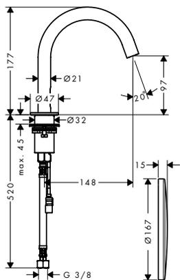
Mitigeur lavabo électronique 100 avec température pré-réglable sur secteur
