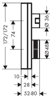
Thermostatique 172/172 mm avec robinet d'arrêt/inverseur pour 2 systèmes - set de finition
