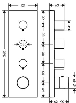
Module thermostatique 360/120 mm pour 3 systèmes - set de finition square
