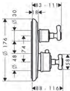
Thermostatique Ø 170 mm avec robinet d'arrêt pour 1 système, poignée cruciforme - set de finition round
