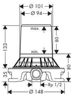
Corps d'encastrement pour mitigeur/thermostatique à poser
