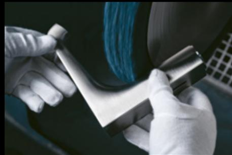
Поверхности AXOR FinishPlus PVD обладают характером. Каждый цвет является результатом интенсивного исследования и доработки в вакуумных камерах AXOR с использованием процесса PVD (физического осаждения паров). Электрическая дуга разряжается в высоком вакууме, газы соединяются с цирконием. Смесь попадает на хромированную поверхность смесителя. Этот высокотехнологичный процесс придает поверхности беспрецедентный блеск и высокую устойчивость к царапинам, чистящим средствам и солям морского воздуха.
